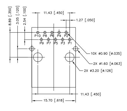
RECOMMENDED PWB LAYOUT (COMPONENT SIDE SHOWN)
