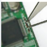
Measuring Small Electronic Components Messung von kleinen elektronischen Bauteilen 測試SMD等小型電子元件
