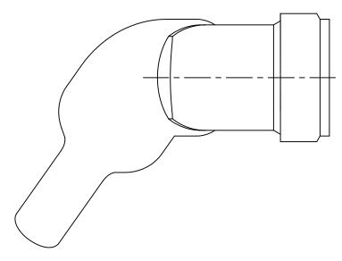
SPIN-LOCK ADAPTER, HEAT SHRINKABLE MOLDED PART, SEALED
