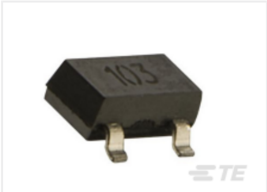
TE Part #G-NICO-001 NI 1000 DIN 43760 KL.B SOT23
