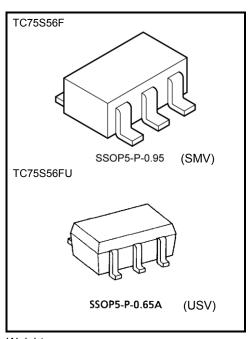
Weight SSOP5-P-0.95 : 0.014 g (typ.) SSOP5-P-0.65A : 0.006 g (typ.)
