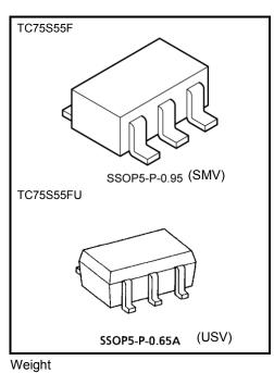
SSOP5-P-0.95 : 0.014 g (typ.) SSOP5-P-0.65A : 0.006 g (typ.)
