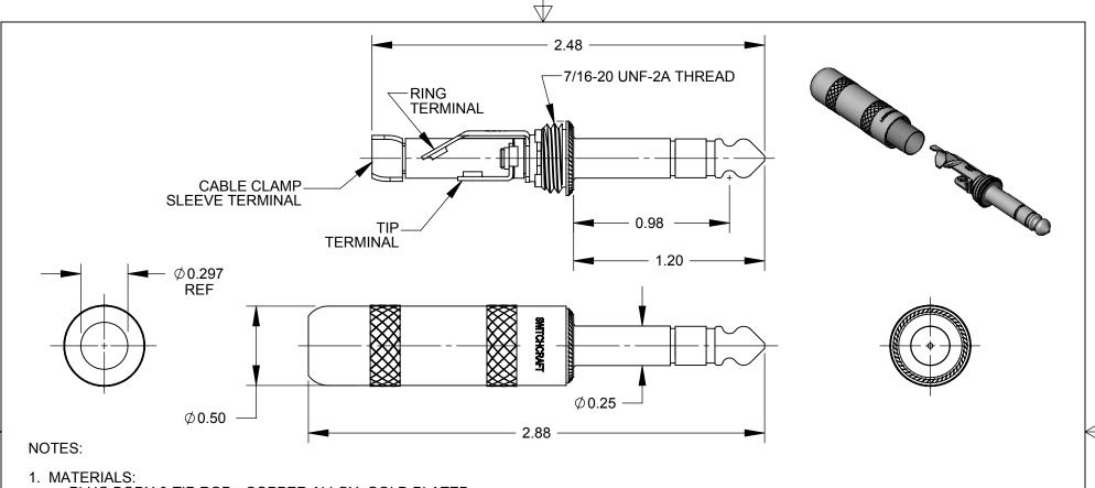
PLUG BODY & TIP ROD - COPPER ALLOY, GOLD PLATED SOLDER & CLAMP TERMINALS - COPPER ALLOY, TIN PLATED INSULATORS - THERMOPLASTIC HANDLE - COPPER ALLOY, BLACK FINISH INSULATOR TUBE - MYLAR
