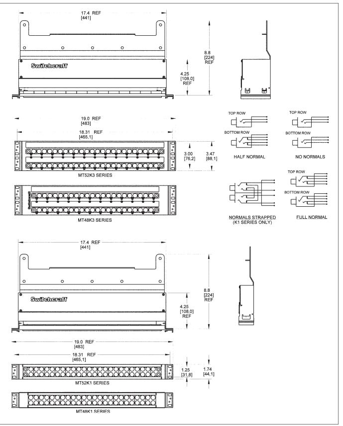
DIMENSIONS ARE FOR REFERENCE ONLY  $\frac{\text{lnch}}{(\text{mm})}$
