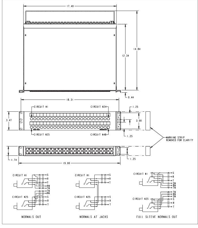
DIMENSIONS ARE FOR REFERENCE ONLY  $\frac{\text{lnch}}{(\text{mm})}$
