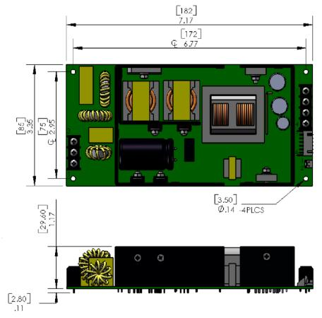
MAX LEAD PROTRUSION
