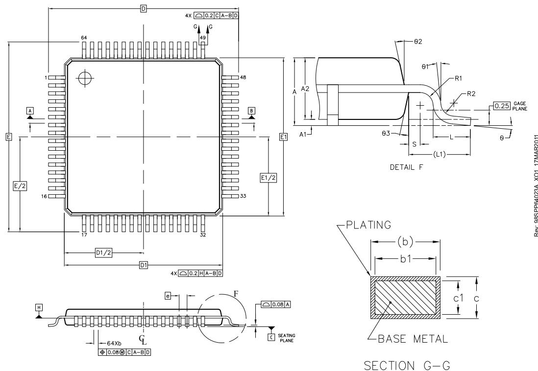
**Figure 8.1. TQFP64**
