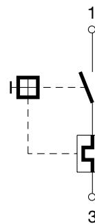
Shunt terminal T11-...N  $\leq 6,5\text{A}$
