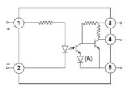
1,2 : Field VDC 3 : Vcc 4 : Logic 5 : Ground (A) LED
