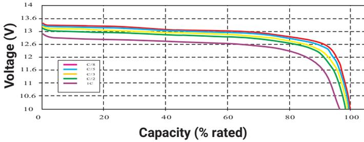
**DISCHARGE VOLTAGE PROFILES AT 0.5C DISCHARGE RATE
