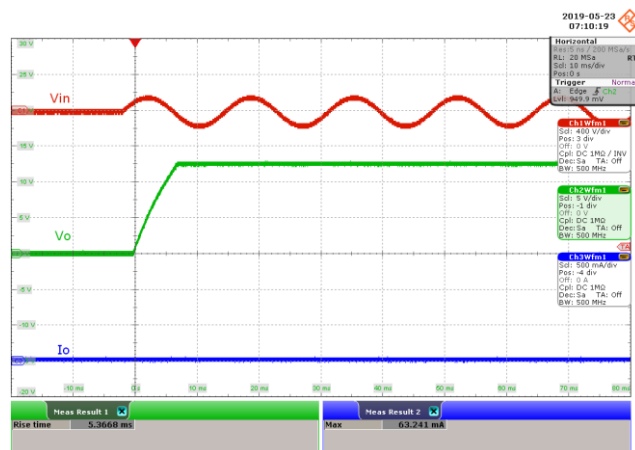
CH1: V_{IN} , 400 V / div., 10 ms / div. CH2: V_{OUT} , 5 V / div., 10 ms / div. CH3: I_{OUT} , 500 mA / div., 10 ms / div. Rise Time = 5.3668 ms.
