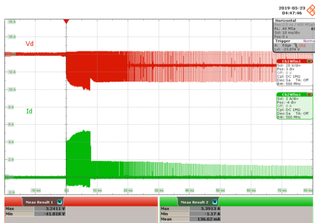
Figure 67 – 85 VAC 60 Hz. CH1: V_D , 20 V / div., 10 ms / div. CH2: I_D , 2 A / div., 10 ms / div. PIV = 41.818 V, I_{D(MAX)} = 5.3913 A.
