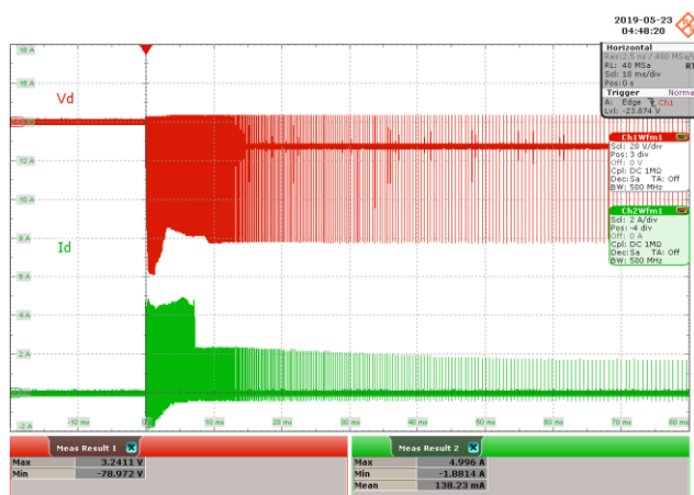
Figure 69 – 230 VAC 50 Hz. CH1: V_D , 20 V / div., 10 ms / div. CH2: I_D , 2 A / div., 10 ms / div. PIV = 78.972 V, I_{D(MAX)} = 4.996 A.
