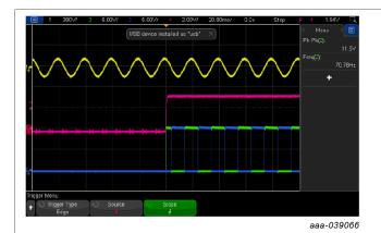
CH1: AC mains (300 V/div) CH2: GATELR (5 V/div) CH3: GATELL (5 V/div) CH4: COMP (2 V/div) Time: 20 ms/div
