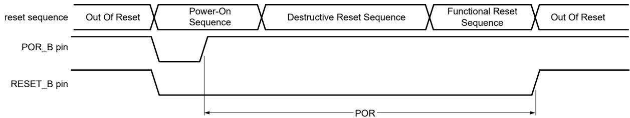
Figure 17. POR due to POR_B pin assertion
