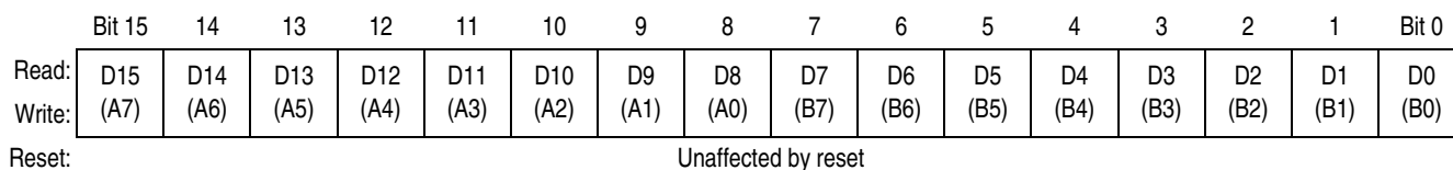
Figure 3-4. Accumulator D (D)
