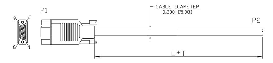
1. P1. CONNECTOR: NORCOMP MICRO D 9S, ASSEMBLED HOOD W/THUMBSCREWS
