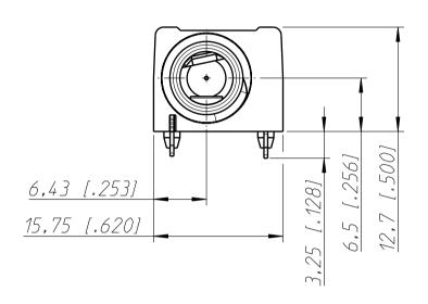
Frontplattenausschnitt (Rückseite) Panel cut out (rear side)
