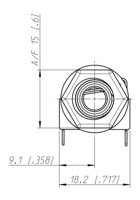
Frontplattenausschnitt (Rückseite) Panel cut out (rear side)
