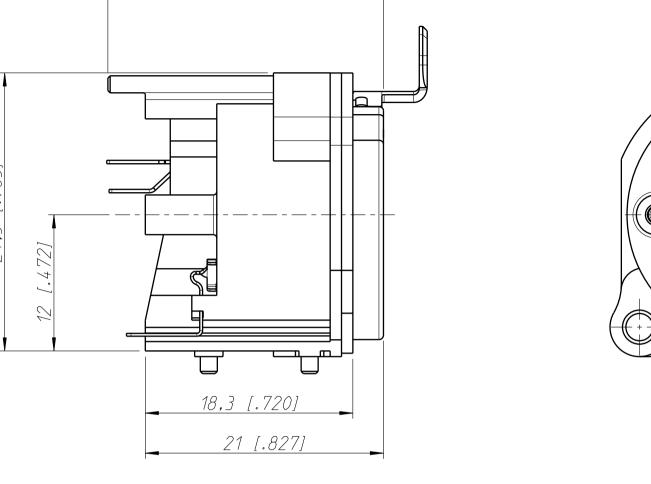
Frontplattenausschnitt (Rueckseite) Panel cut-out (rear side)
