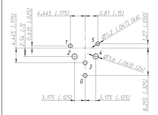
Frontplattenausschnitt (Rückseite) Panel cut out (rear side)
