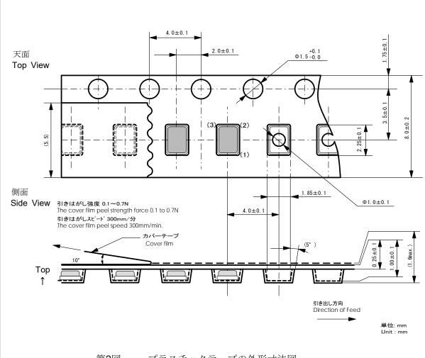
第2図 プラスチックテープの外形寸法図
