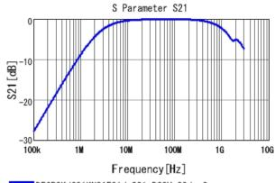
DE6B3KJ681KN3AE01J S21 DC0V, 20degC
