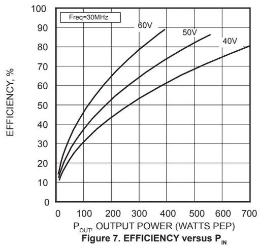
Figure 7. EFFICIENCY versus P<sub>IN</sub>
