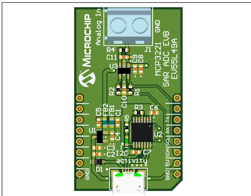
**FIGURE 1-1:** MCP3221 SAR ADC Evaluation Board.
