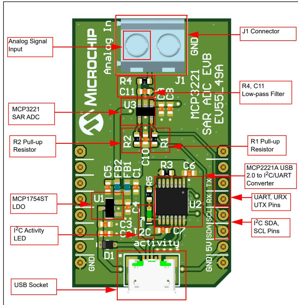
**FIGURE 2-1:** MCP3221 SAR ADC Evaluation Board.
