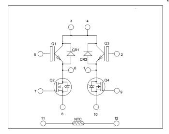
Top switches : Trench + Field Stop IGBT<sup>®</sup> Bottom switches : CoolMOS<sup>TM</sup>
