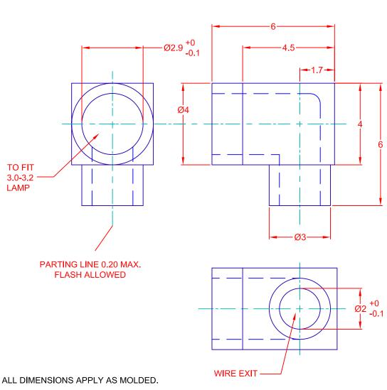
MATERIAL: SILICONE RUBBER/UL94V-0
