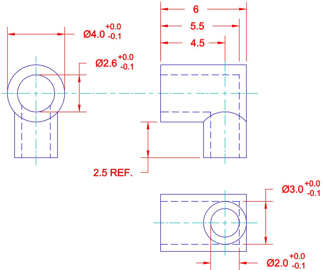
MATERIAL: SILICONE RUBBER UL94V-0
