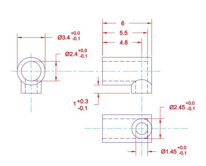
MATERIAL: DOW CORNING SILICONE UL94V-0 54 SHORE HARDNESS
