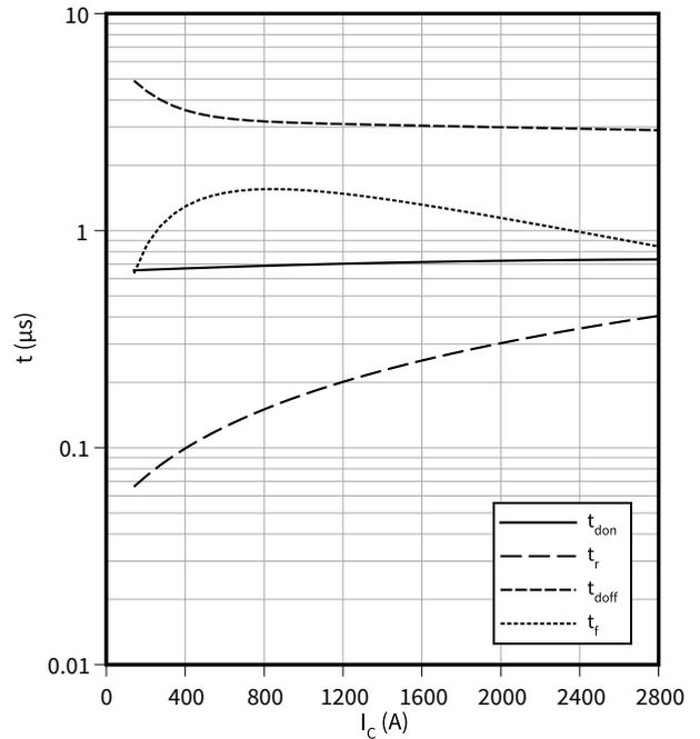
**Schaltzeiten (typisch), IGBT, Wechselrichter**
