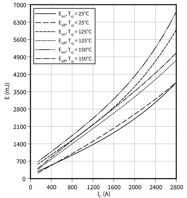
**Schaltverluste (typisch), IGBT, Wechselrichter**
