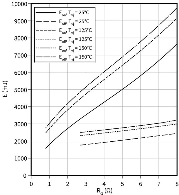
**Schaltzeiten (typisch), IGBT, Wechselrichter**
