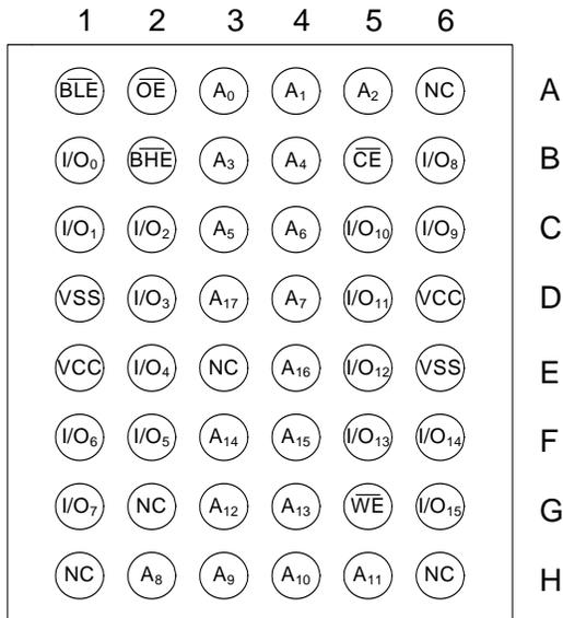
图 2. 带 ERR 的 48-VFBGA (6 × 8 × 1.0 mm) 单芯片使能, CY7C1041GE<sup>[4, 5]</sup> 封装 / 等级 ID: BVXI<sup>[6]</sup>
