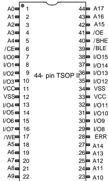
图 6. 无 ERR 的 44-TSOP II/44-SOJ 单芯片使能 CY7C1041G<sup>[7]</sup>
