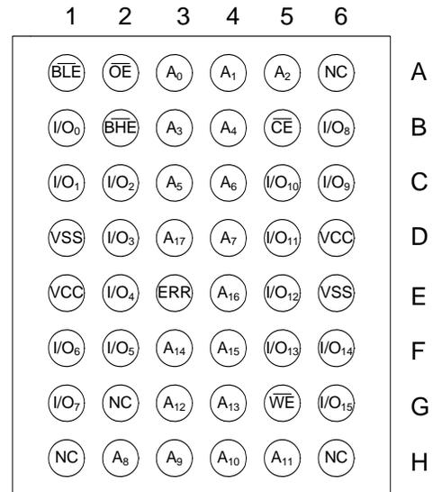
图 3. 4 无 ERR 的 48-VFBGA (6 × 8 × 1.0 mm) 单芯片使能, CY7C1041G<sup>[4]</sup>, 封装 / 等级 ID: BVJXI<sup>[6]</sup>
