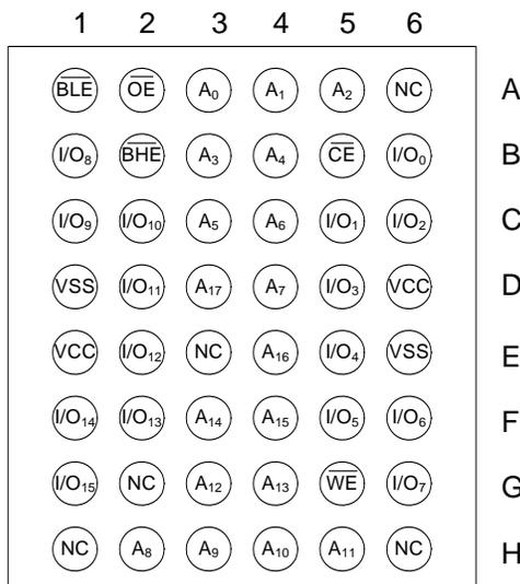
图 4. 带 ERR 的 48-VFBGA (6 × 8 × 1.0 mm) 单芯片使能, CY7C1041GE<sup>[4, 5]</sup>, 封装 / 等级 ID: BVJXI<sup>[6]</sup>
