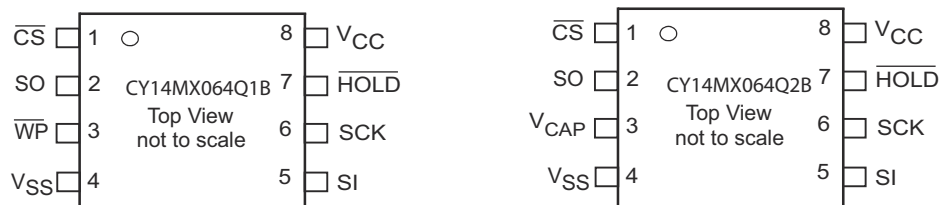
図 1. 8 ピン SOIC ピン配列 [1, 2]
