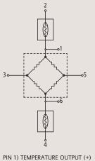
PIN 2) Vs PIN 3) +Vo PIN 4) Gnd PIN 5) -Vo PIN 6) TEMPERATURE OUTPUT (-)
