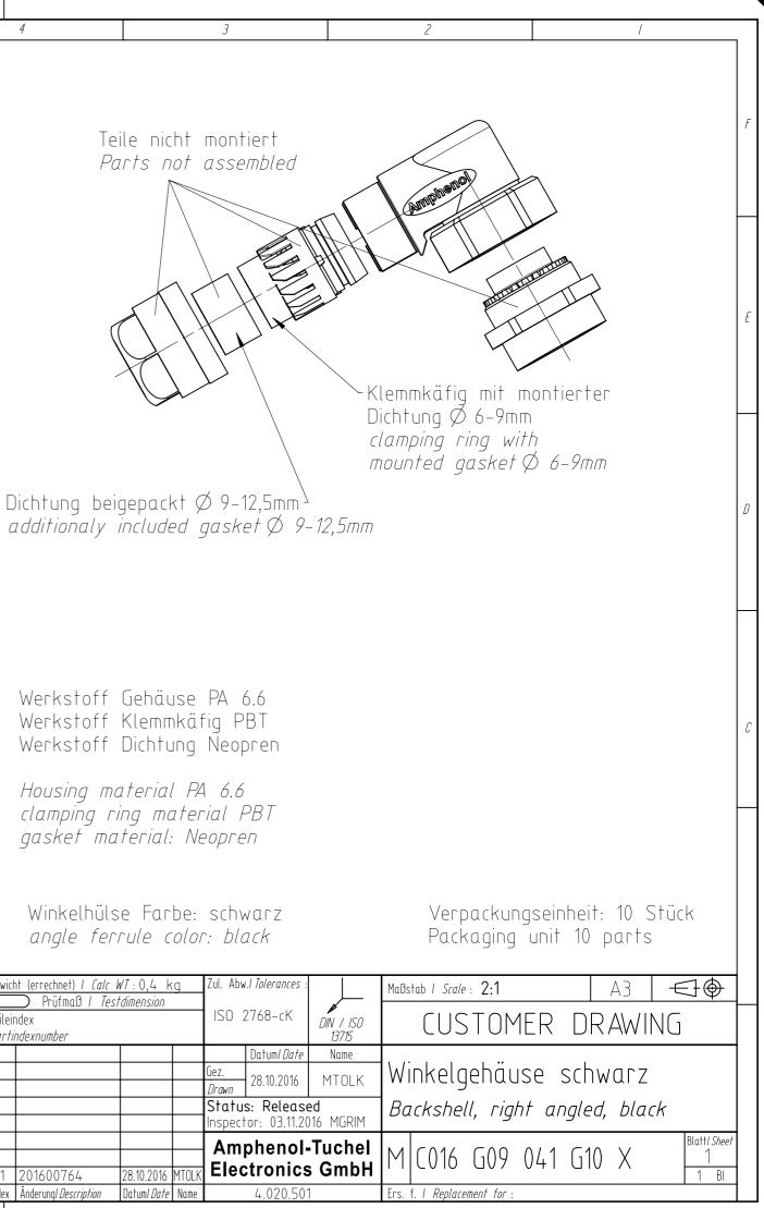
Werkstoff Gehäuse PA 6.6 Werkstoff Klemmkäfig PBT Werkstoff Dichtung Neopren
