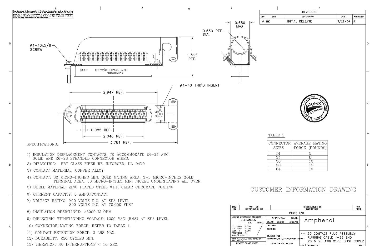
14) OPERATING TEMPERATURE:  $-55^{\circ}$ C TO  $+105^{\circ}$ C ( $-67^{\circ}$ F TO  $+221^{\circ}$ F)
