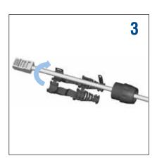
Install the cable clamp-boot.
