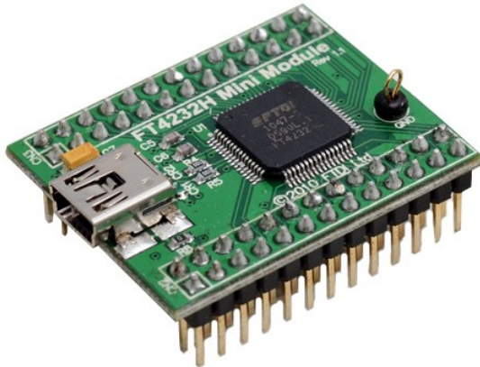
Figure 1.1 - FT4232H Mini Module
