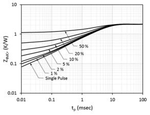
Fig. 17 Max. thermal transient impedance (Z $_{\rm thJC})$  vs. pulse width (t $_{\rm p})$
