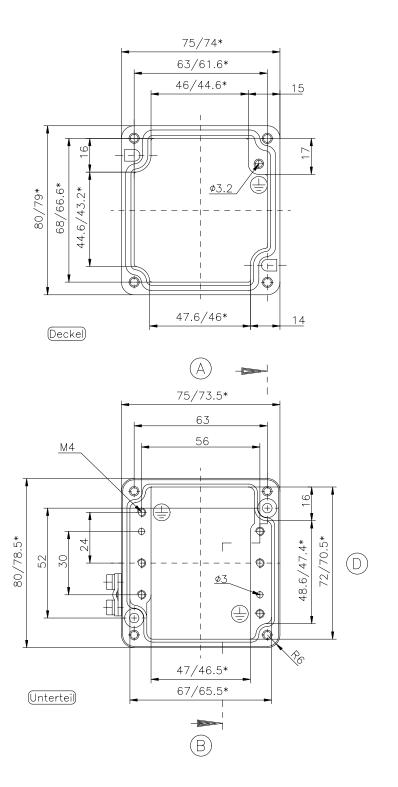
\* = Mass durch Formkonizität nach unten verringert. Freimass — Toleranz nach GTA 13/5 DIN 1688
