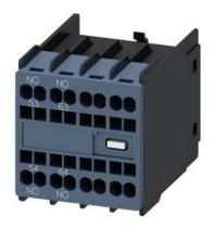
auxiliary switch, on the front, 2 NO, 53/54, 63/64, --/--, --/--, current path: 1 NO, 1 NO, --, --, spring-loaded terminal, for contactors 3RT2 and contactor relays 3RH2
