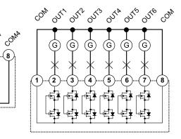
Fig. 6 M F I6 O6: opto-mosfet outputs
