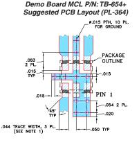
NOTES: 1. TRACE WIDTH IS SHOWN FOR ROGERS R04350B WITH DIELECTRIC THICKNESS .020" ± .0015"; COPPER: 1/2 0Z. ON EACH SIDE. FOR OTHER MATERIALS TRACE WIDTH MAY NEED TO BE MODIFIED. 2. BOTTOM SIDE OF THE JPCB IS CONTINUOUS GROUND PLANE. DENOTES FOB COPPER LAYOUT WITH SMOBE (SOLDER MASK OVER BARE COPPER) DENOTES COPPER LAND PATTERN FREE OF SOLDER MASK
