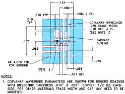
2. BOTTOM SIDE OF THE PCB IS CONTINUOUS GROUND PLANE. DENOTES PCB COPPER LAYOUT WITH SMOBC (SOLDER MASK OVER BARE COPPER).
