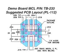
NOTES: 1.TRACE WIDTH IS SHOWN FOR ROGERS R04350B WITH DIELECTRIC THICKNESS 0.020° ± 0.0015°; COPPER: 1/2 0Z. EACH SIDE. FOR OTHER MATERIALS TRACE WIDTH MAY NEED TO BE MODIFIED. 2.BOTTOM SIDE OF THE FOE IS CONTINUOUS GROUND PLANE.
