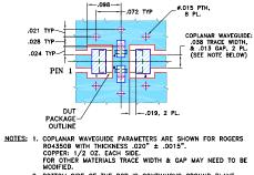
2. BOTTOM SIDE OF THE PCB IS CONTINUOUS GROUND PLANE. DENOTES PCB COPPER LAYOUT WITH SMOBC (SOLDER MASK OVER BARE COPPER)
