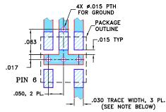
NOTES: 1. TRACE WIDTH IS SHOWN FOR ROGERS RO4350B WITH DIELECTRIC THICKNESS 0.030" ± 0.002"; COPPER: 1/2 0Z. EACH SIDE. FOR OTHER MATERIALS TRACE WIDTH MAY NEED TO BE MODIFIED. 2. BOTTOM SIDE OF THE PCB IS CONTINUOUS GROUND PLANE.
