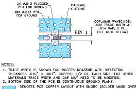
DENOTES PCB COPPER LAYOUT WITH SMOBC (SOLDER MASK OVER BARE COPPER).
