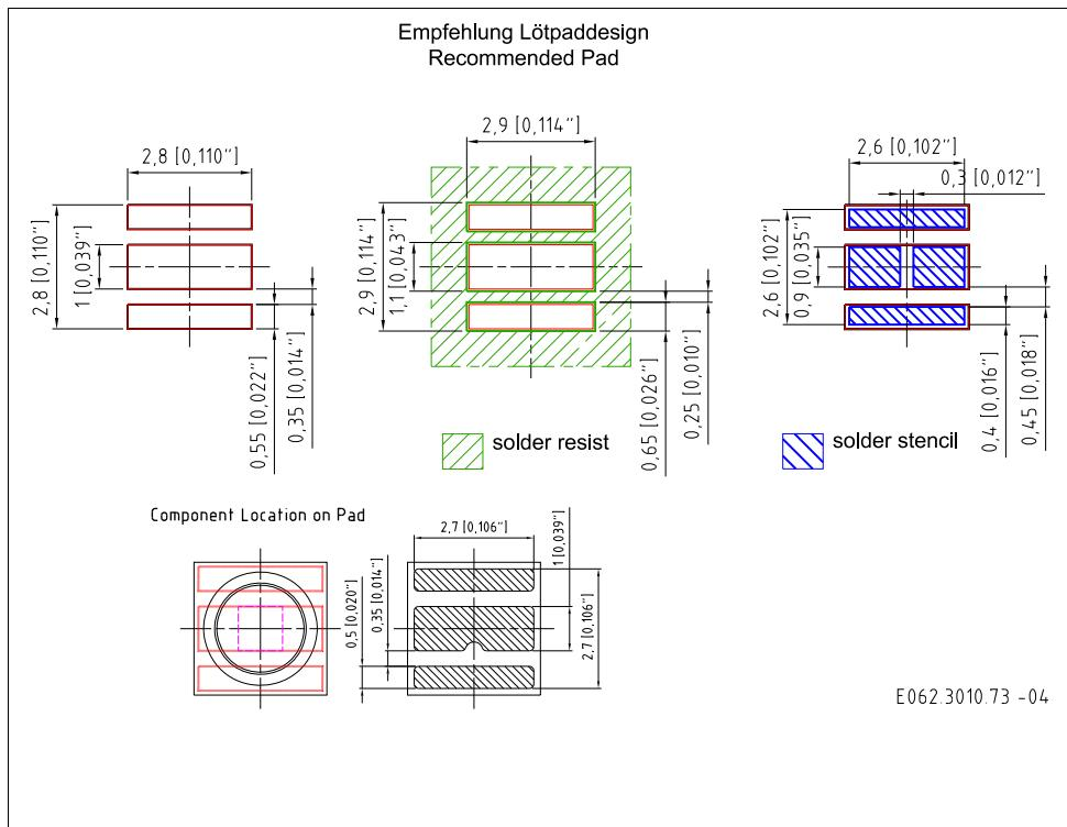
Anm.: Um eine verbesserte Lötstellenkontaktierung zu erreichen, empfehlen wir, unter Standardstickstoffatmosphäre zu löten.
