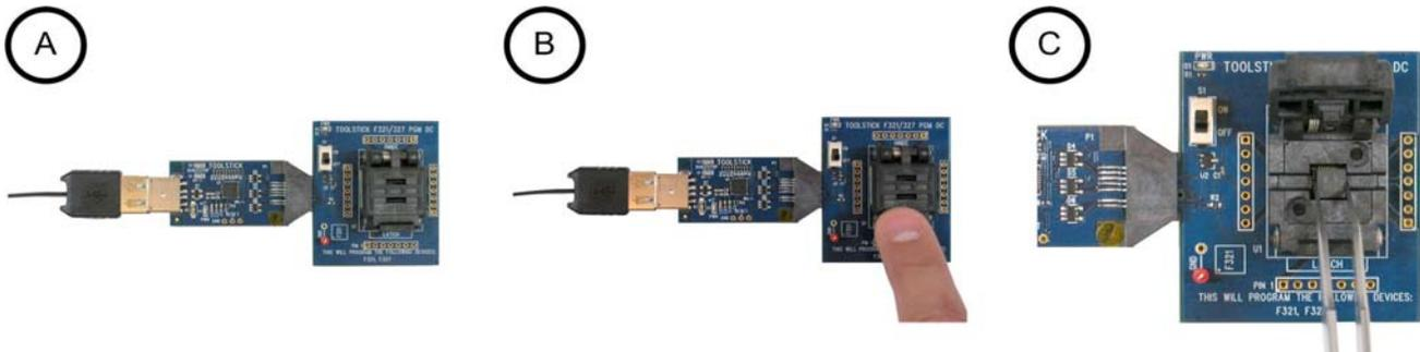
**Figure 8. Clam-Shell Socket**
